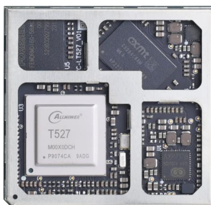
图 3-3 核心板 100%国产物料外观
